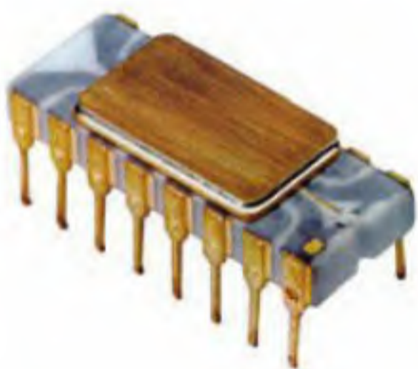
Rys. 10. Mikrokontroler 4004 – protoplasta współczesnych mikroprocesorów
