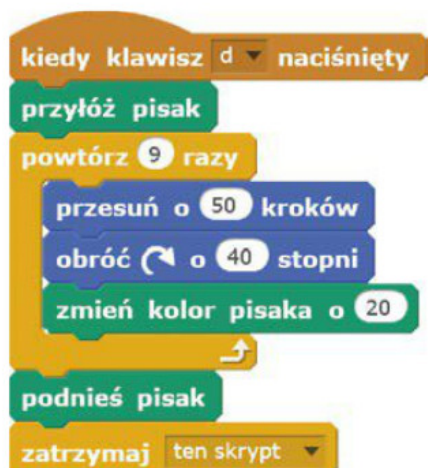
Rys. 8. Skrypt określający rysowanie dziewięciokąta o różnych kolorach boków i efekt jego wykonania
