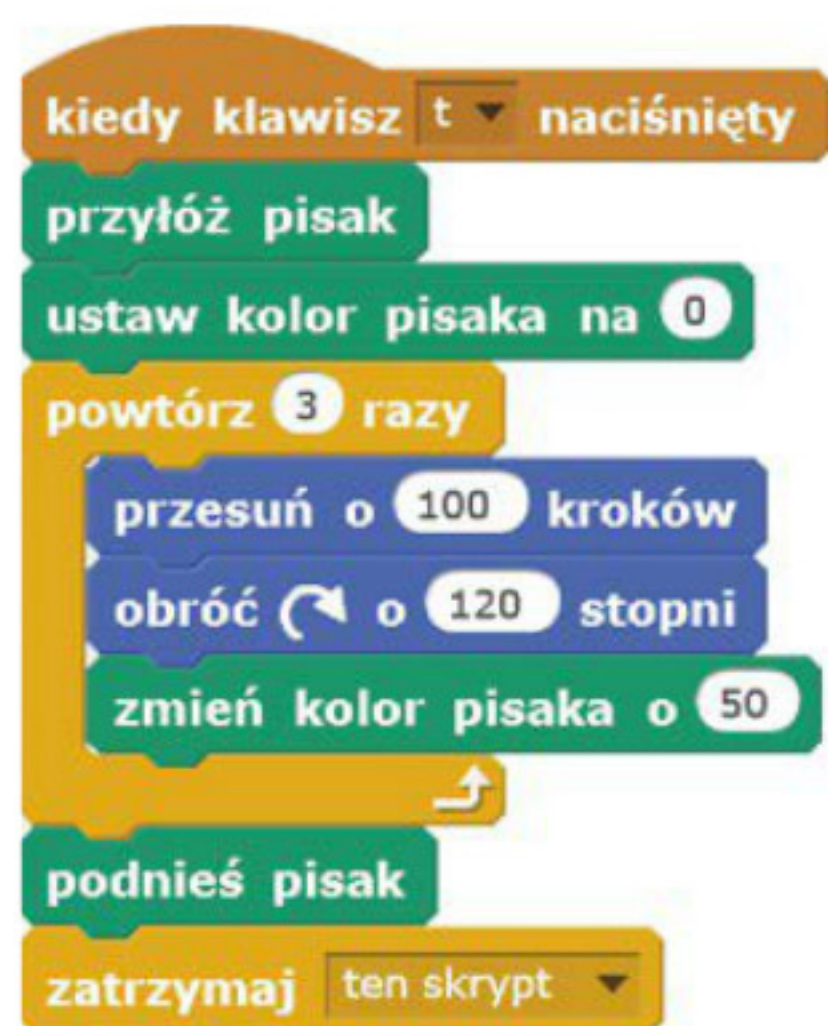
Rys. 7. Skrypt określający rysowanie trójkąta o różnych kolorach boków i efekt jego wykonania
